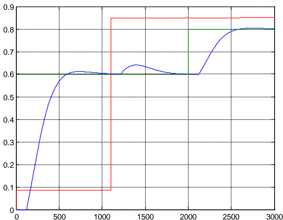
Рисунок 7 – Переходная характеристика по уровню выпарного аппарата с учетом внешних возмущений и изменения сигнала уставки
