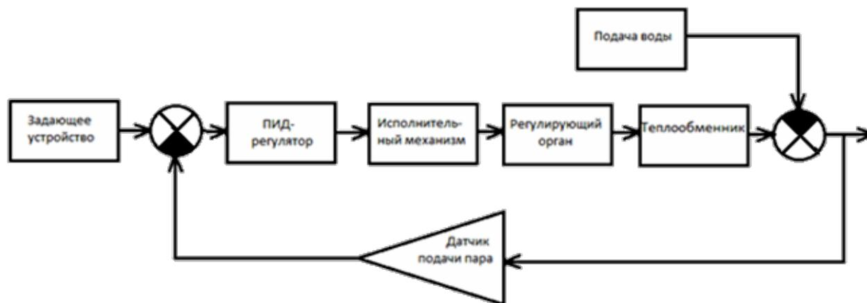
Рисунок 4 – Структурная схема САУ температуры в теплообменнике
