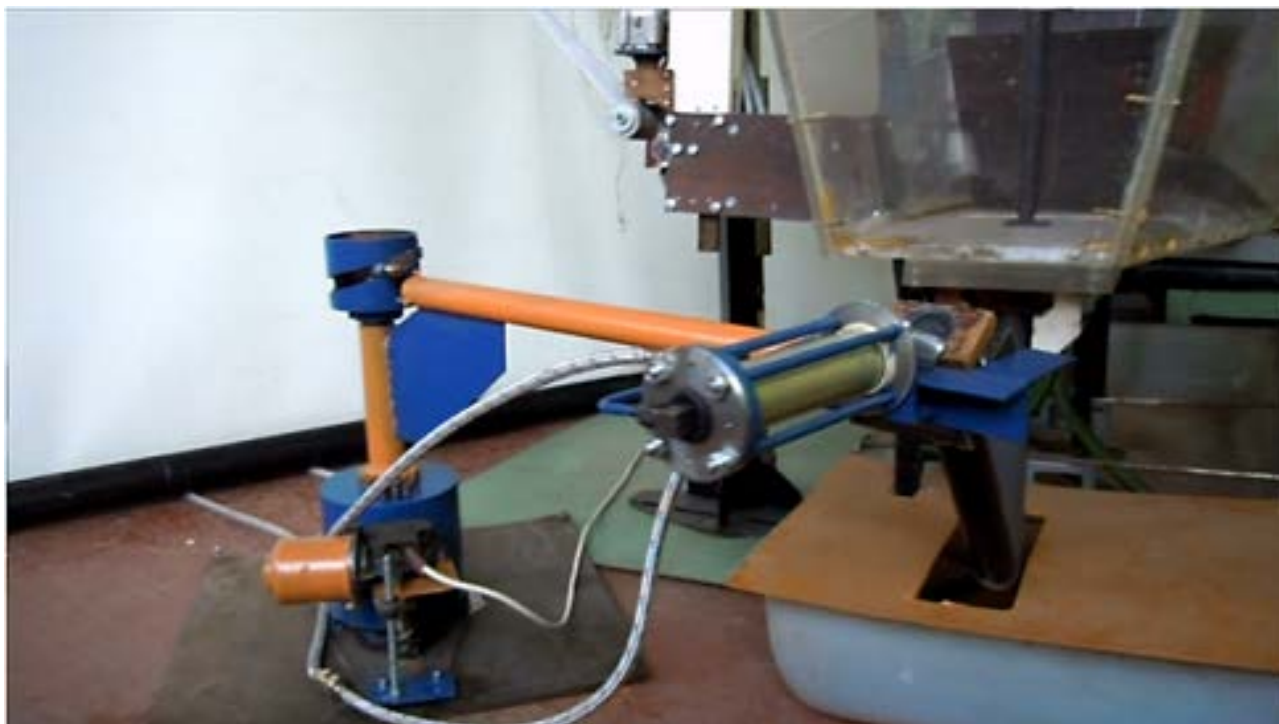
Рисунок 4 – Физическая модель системы быстрой замены погружных стаканов для серийной разливки стали
