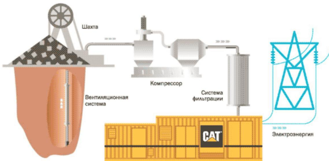
Рисунок 3 – Выработка электроэнергии с помощью дизель-генераторов
