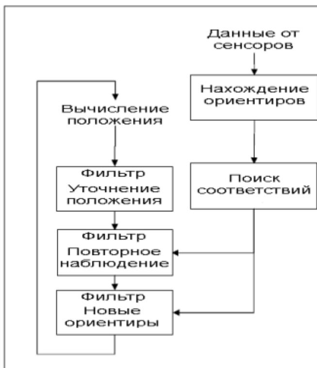
Рисунок 1 - Блок-схема SLAM-алгоритма
