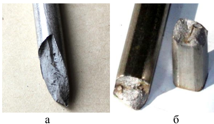
Рисунок 1 – Макроструктура изломов проволоки диам. 8,5 мм и поката 5,5x5 мм
