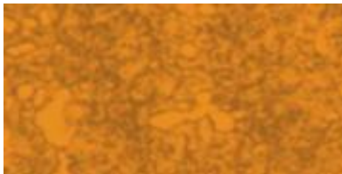
Рисунок 1- Структура стали X12M после закалки 950°C.
