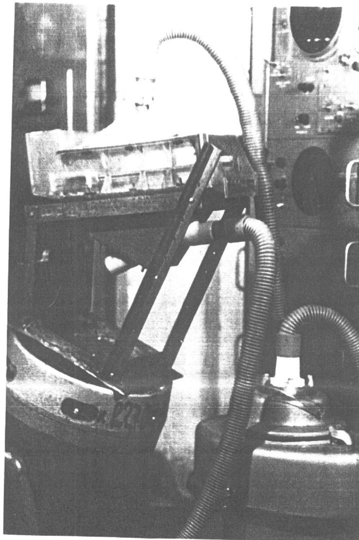
Рисунок 2.23. Общий вид лабораторной установки пневмовибрационного сепаратора для разделения лома цветных металлов.
