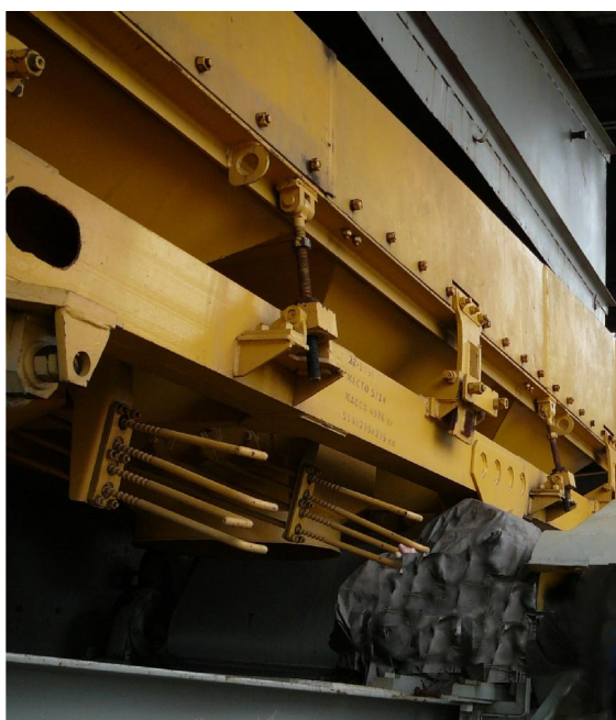
Рис. 1.30. Общий вид сепаратора СВП-5,5х1 (без кожуха)
