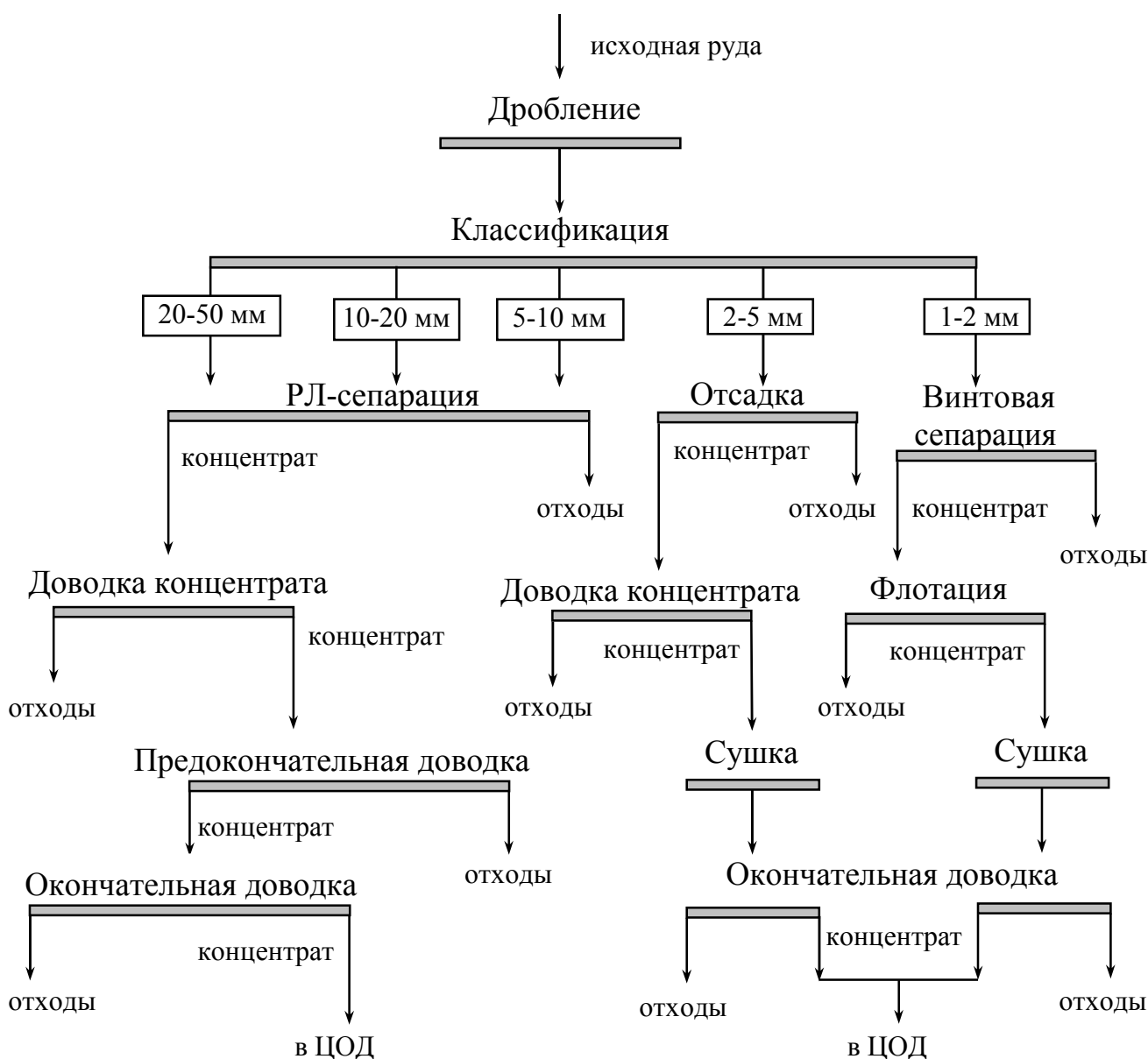
Рис. 1.16. Схема обогащения алмазосодержащих кимберлитовых руд
