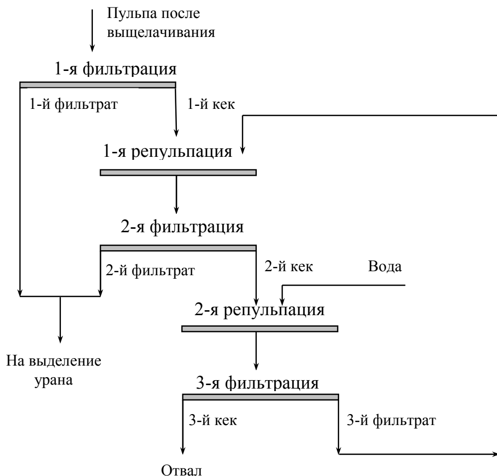
Рис. 1.8. Общая схема проведения процесса отмывки осадка после выщелачивания
