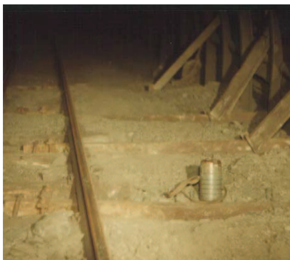
Рисунок 5 — Расположение металлических лежней и опорных стоек по почве конвейерного штрека 7-ой восточной лавы пласта l_8^1
