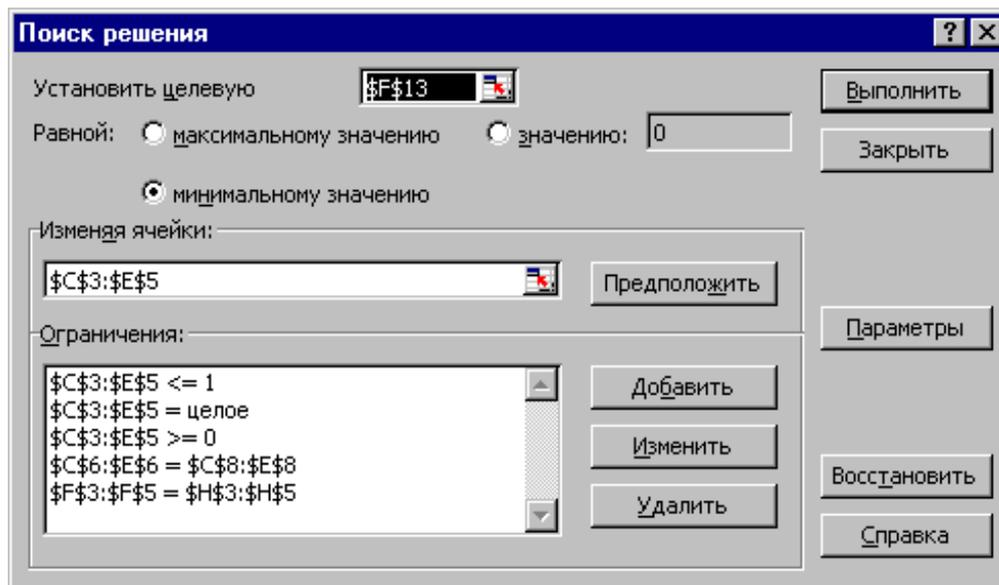
Рис.1.20. Окно "Поиск решения" для задачи с булевыми переменными, представленной на рис.1.18
