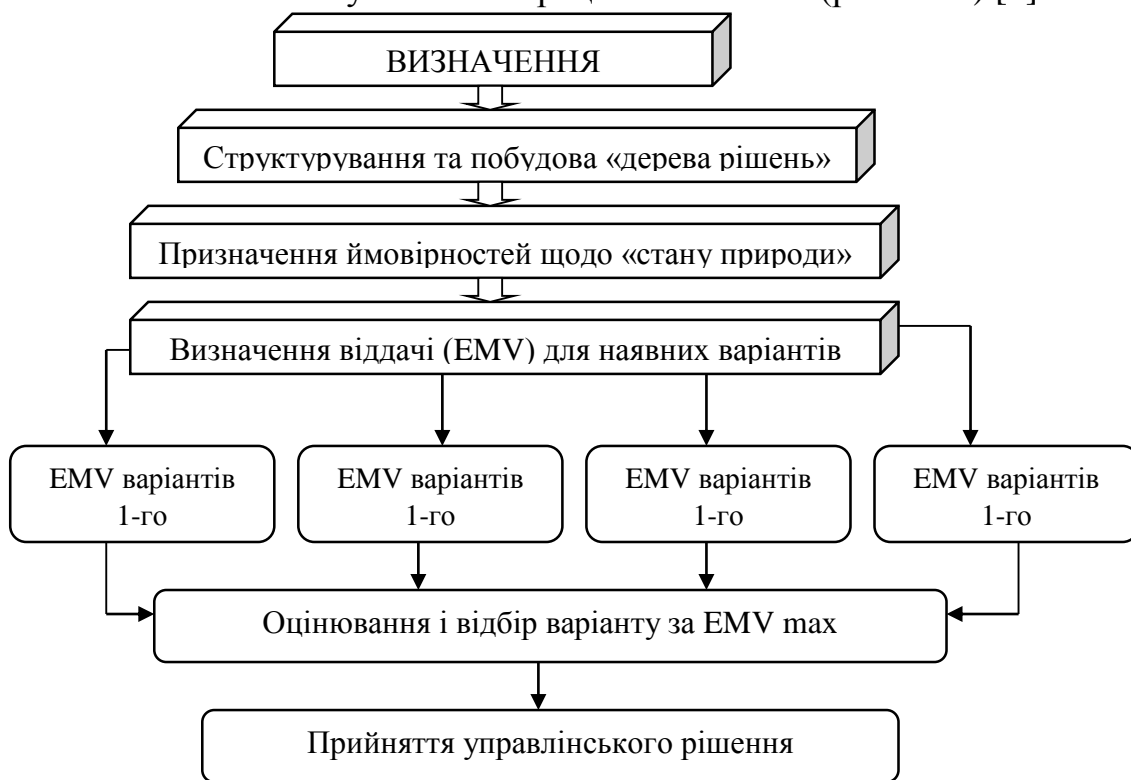
Рис. 2.10 - Процедура створення «дерева рішень» у ході проектування продукту в системі операційного менеджменту
