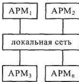
Рис. 2.2. Функциональная структура одноранговой архитектуре сети.
