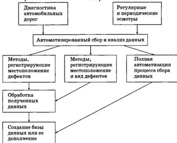
Рисунок 1.13 – Схема процесса регистрации дефектов и их дальнейшей обработки
