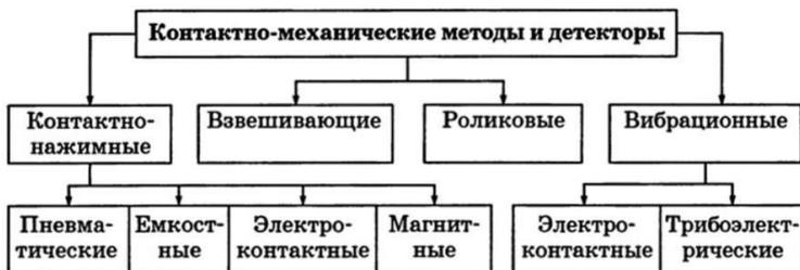
Рисунок 2.1 – Классификация контактно-механических методов и детекторов транспорта
