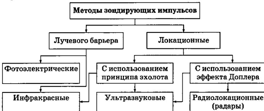
Рисунок 2.3 – Классификация методов и детекторов определения параметров транспортного потока с помощью зондирующих импульсов
