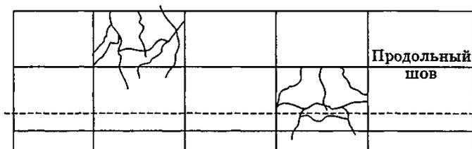
Рисунок 1.12 – Разрушение плит
