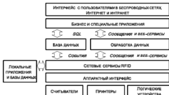
Рис. 7.6. Архитектура приложения RFID Enterprise
