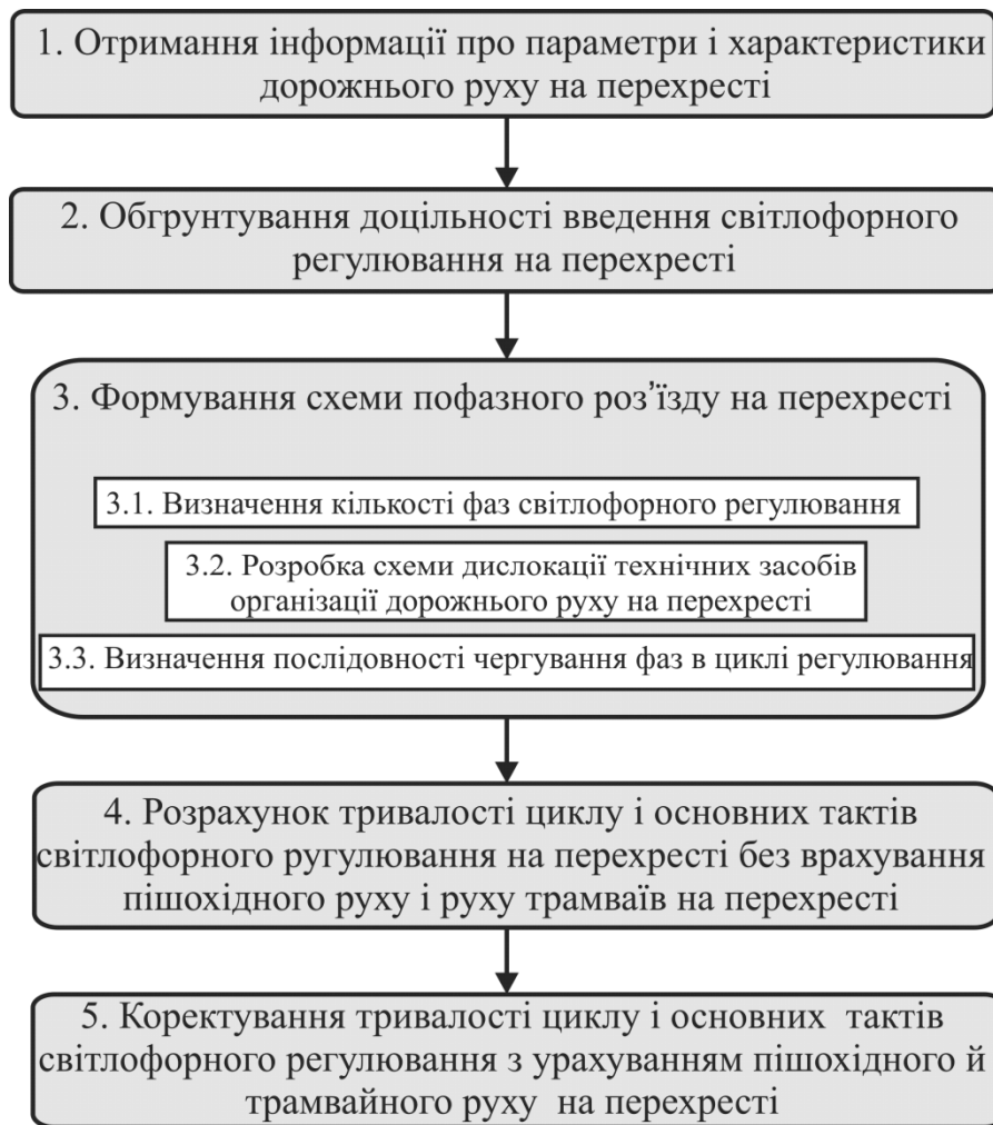
Рисунок 2.2 – Основні етапи методики проектування режиму світлофорного регулювання на ізольованому перехресті
