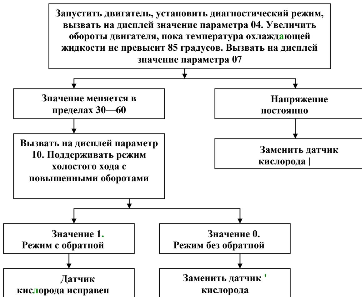
**Рис. 5. Проверка работоспособности датчика кислорода**
