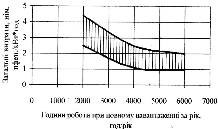
Рисунок 2.4 – Загальні кошти для сухого методу очищення димових газів від SO 2 .
