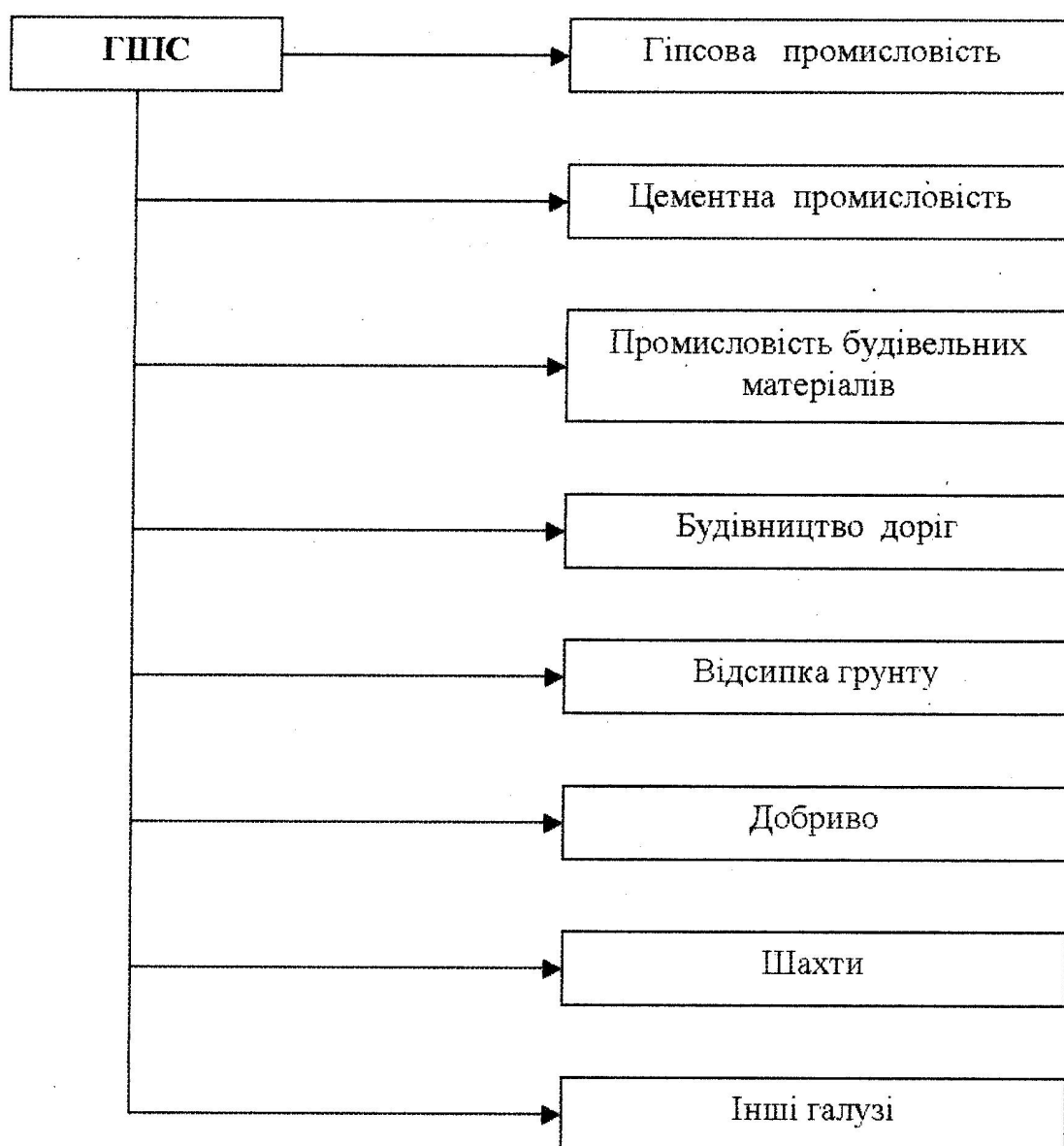
Рисунок 3.8 - Основні напрямки використання гіпсу як побічного продукту очищення димових газів від \text{SO}_2
