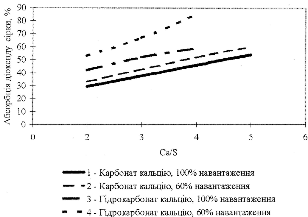
Рисунок 2.1 - Вплив сорбенту та навантаження котлу на абсорбційну ефективність діоксиду сірки
