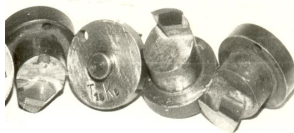
Рисунок 1 - Экспериментальная установка для исследования процессов резания с УЗК -справа и специальные резцовые головки.
