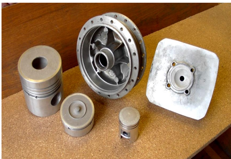
Рисунок 1 – Детали цилиндропоршневой группы (ЦПГ) ДВС
