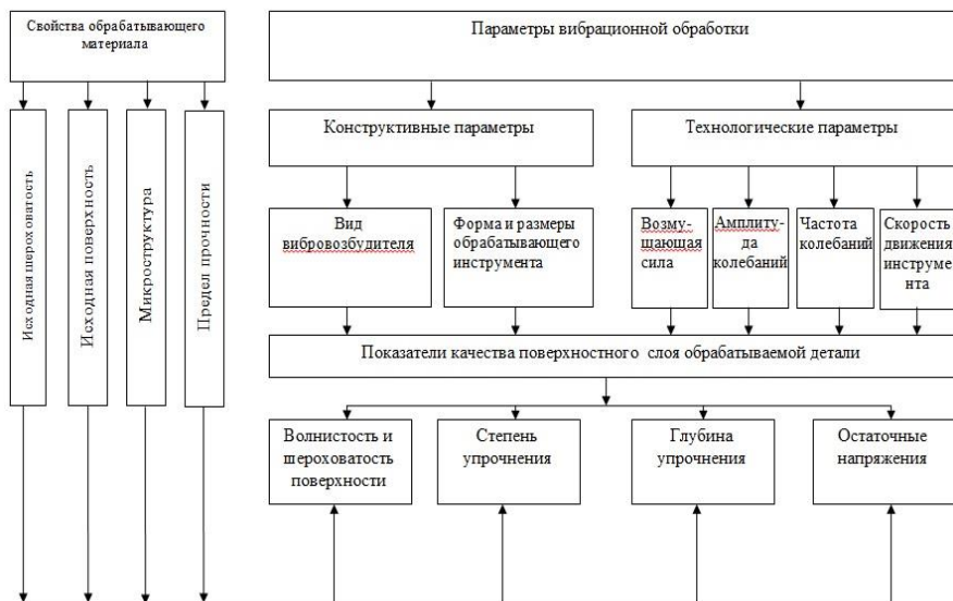
Рис. 1. Параметры вибрационной обработки
