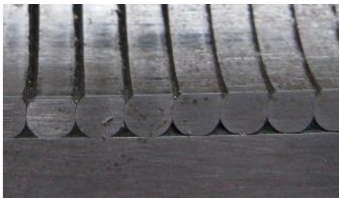
Рис. 3. Составное изделие, образованное при прямом контакте проволоки с инструментом
