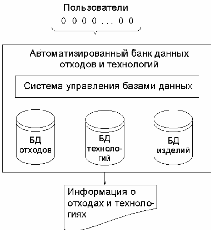
Рис. 6. Структура автоматизированного банка данных по промышленным отходам и технологиям их переработки
