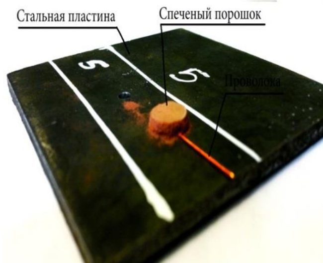
Рис. 4 образец вывода ЭХЗ с пластиной
