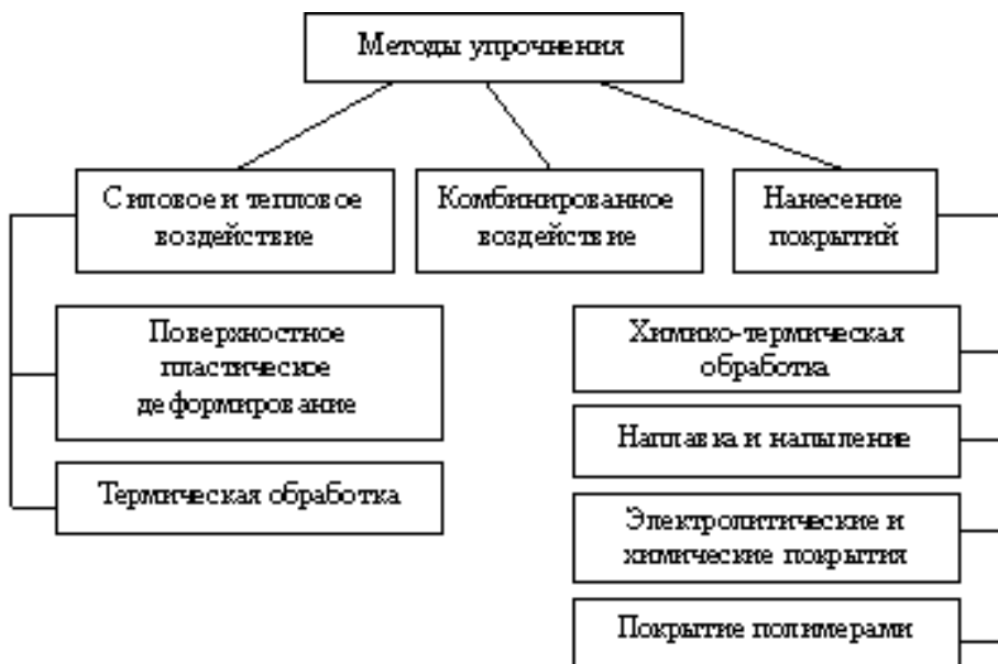
Рис. 1. Методы упрочнения деталей машин
