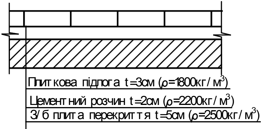
Рисунок 1.2 – Конструкція перекриття
