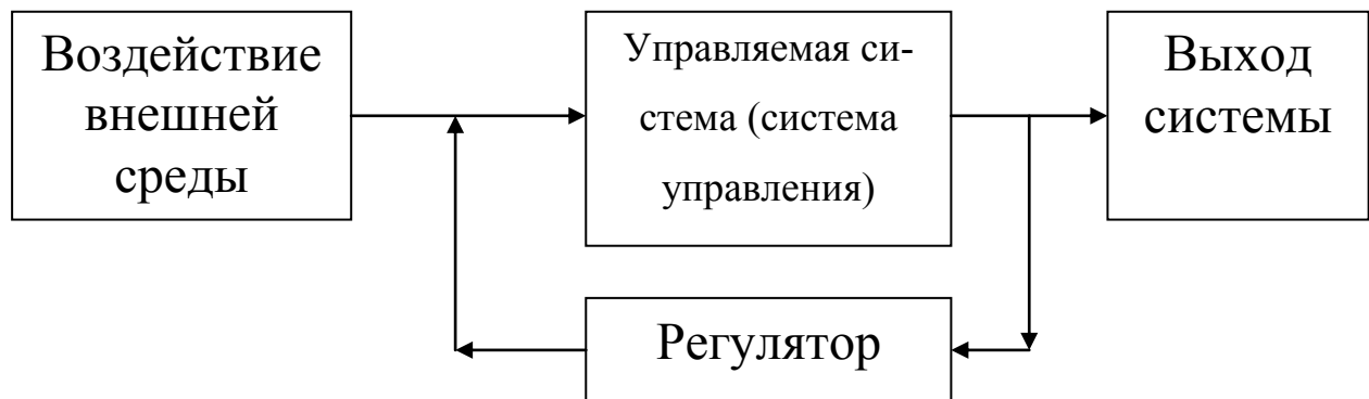
Рис.2. Простейшая схема системы управления с обратной связью
