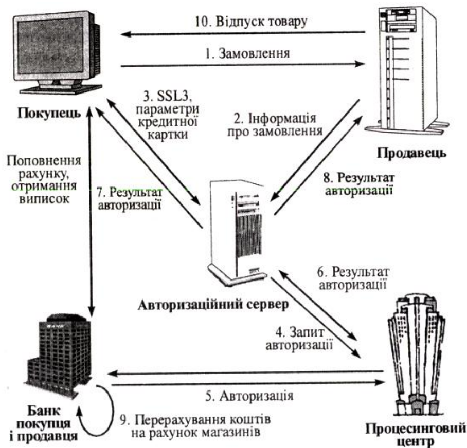
Рис. 2.4. Схема роботи платіжної системи, замкнутої на один банк при обслуговуванні кредитних карток
