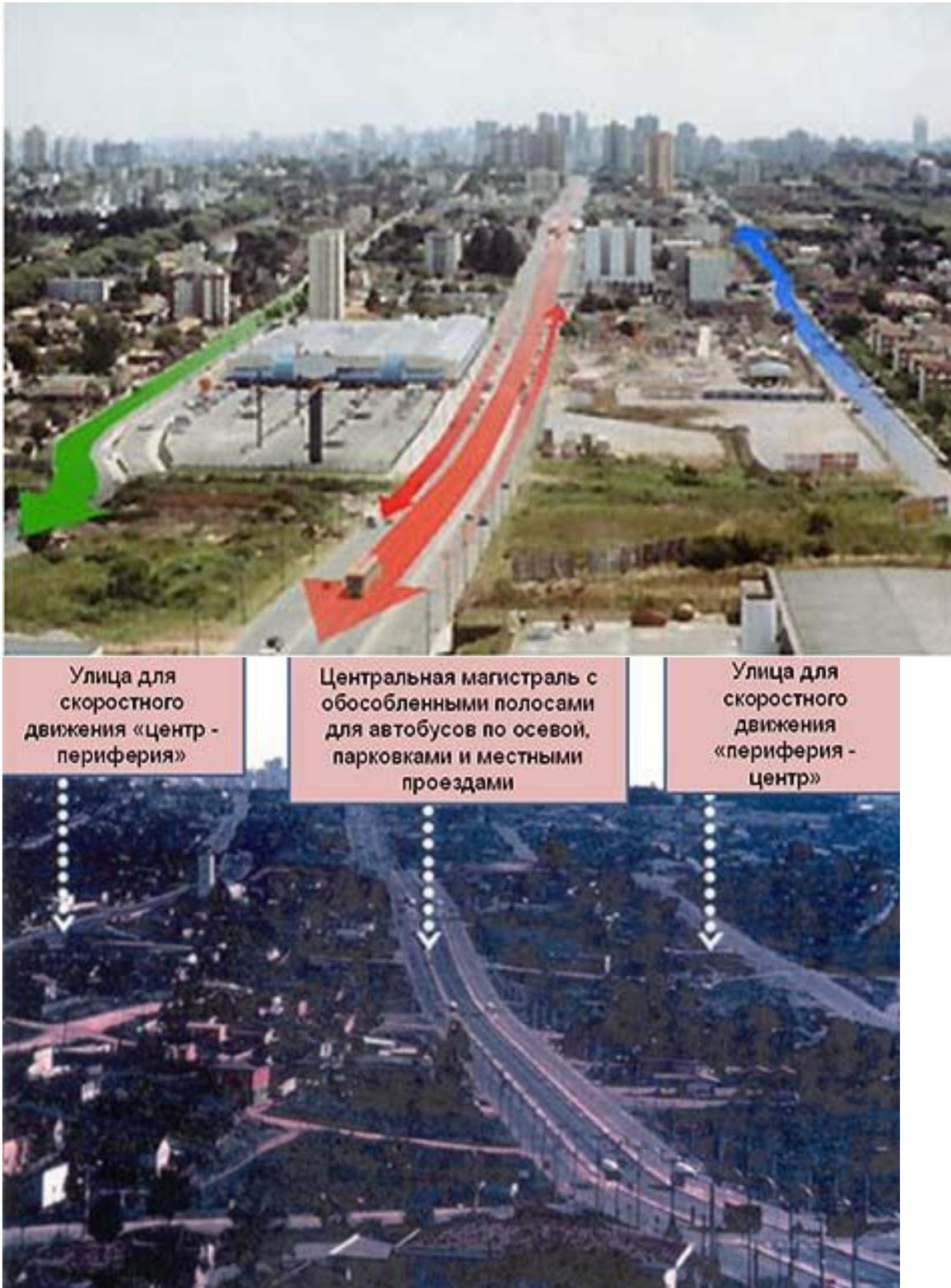
Рис. 7. Схема «трех параллельных улиц»
