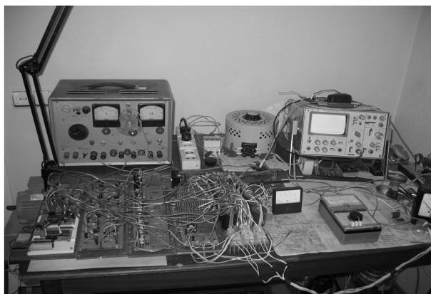
Рисунок 3.б – Лабораторный стенд линейного асинхронного регулируемого электропривода
