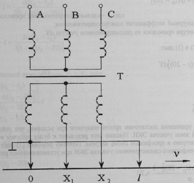
Рисунок 1 – Схема трехфазной установки ЭКН
