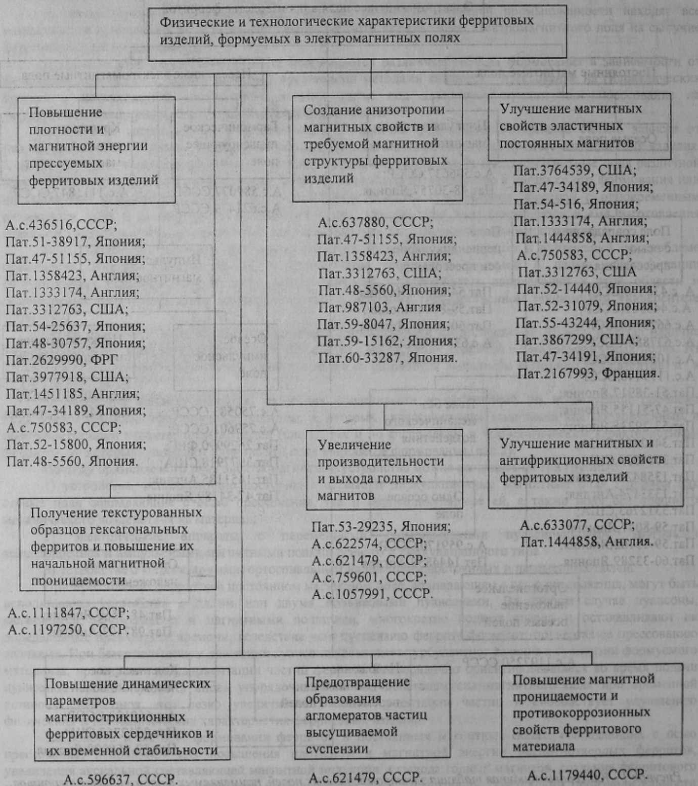
Рисунок 2 - Классификационная таблица физических и технологических характеристик ферритовых изделий, формируемых в электромагнитных полях
