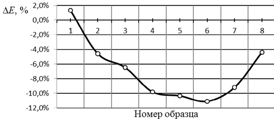
Рисунок 5 – Диаграмма относительной погрешности вычисления энергии деформации
