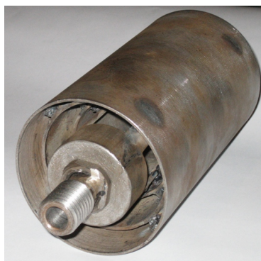
Рисунок 1.- Схема і фотографія багатоканального ежектора: 1 - сопло; 2 - камера; 3 - камера змішування, 4 - циліндри, 5 - дифузор, 6 - конфузюр.
