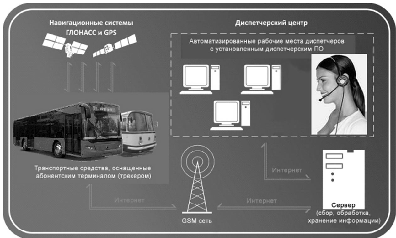
Рисунок 1 – Схема передачи данных в диспетчерский центр АТ
