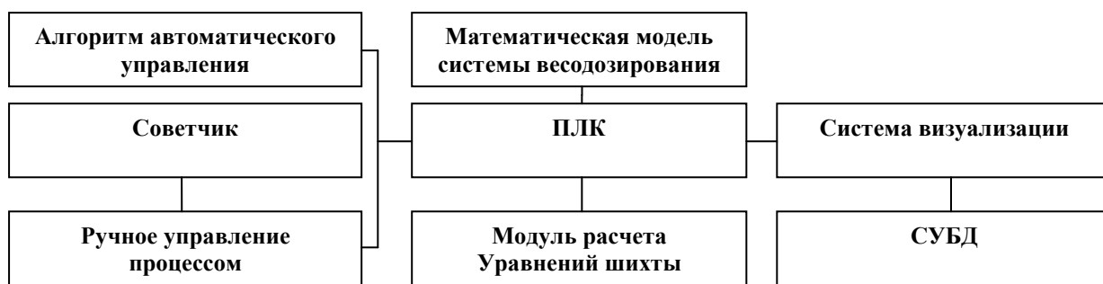
Рисунок 1 – Структура имитационной модели дозирования шихты.
