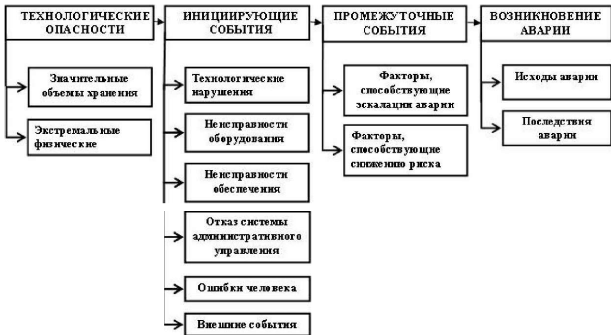
Рисунок 1- Схема развития аварии на химических производствах
