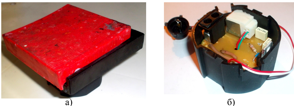
Рисунок 7 – Зовнішній вигляд експериментального зразка модуля безпечного взаємозв'язку і експлуатації НЕМ і вузлів газопостачання приміщення з кришкою (а) і без (б)
