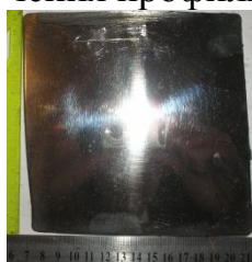
Рисунок 1 – Фотографии темплетов, полученных из НЛЗ с ромбичностью 14 мм (а) и конечного круглого профиля Ø 60 мм (б)
