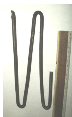
Рисунок 1 - Шихта для ЭКЛ: а-расходуемые электроды; б-кусовой материал (куски спирали Ø6 мм)
