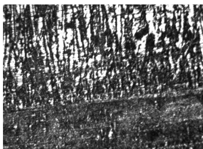
Рисунок 1 – Микроструктура последовательно чередующихся зон зерен меди, x100
