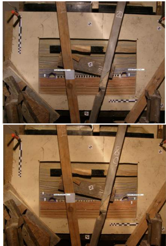
Рис. 8. Деформирование выработок в процессе отработки модели опорами из пенопласта
