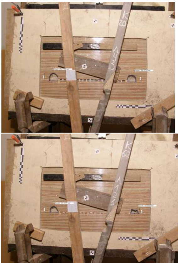
Рис. 9. Деформирование выработок в процессе отработки модели с деревянными опорами
