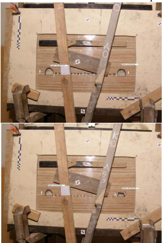
Рис. 9. Деформирование выработок в процессе отработки модели с деревянными опорами
