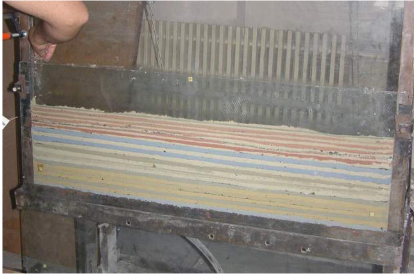
Рис. 4 Общий вид стенда для плоского моделирования методом с использованием эквивалентных материалов
