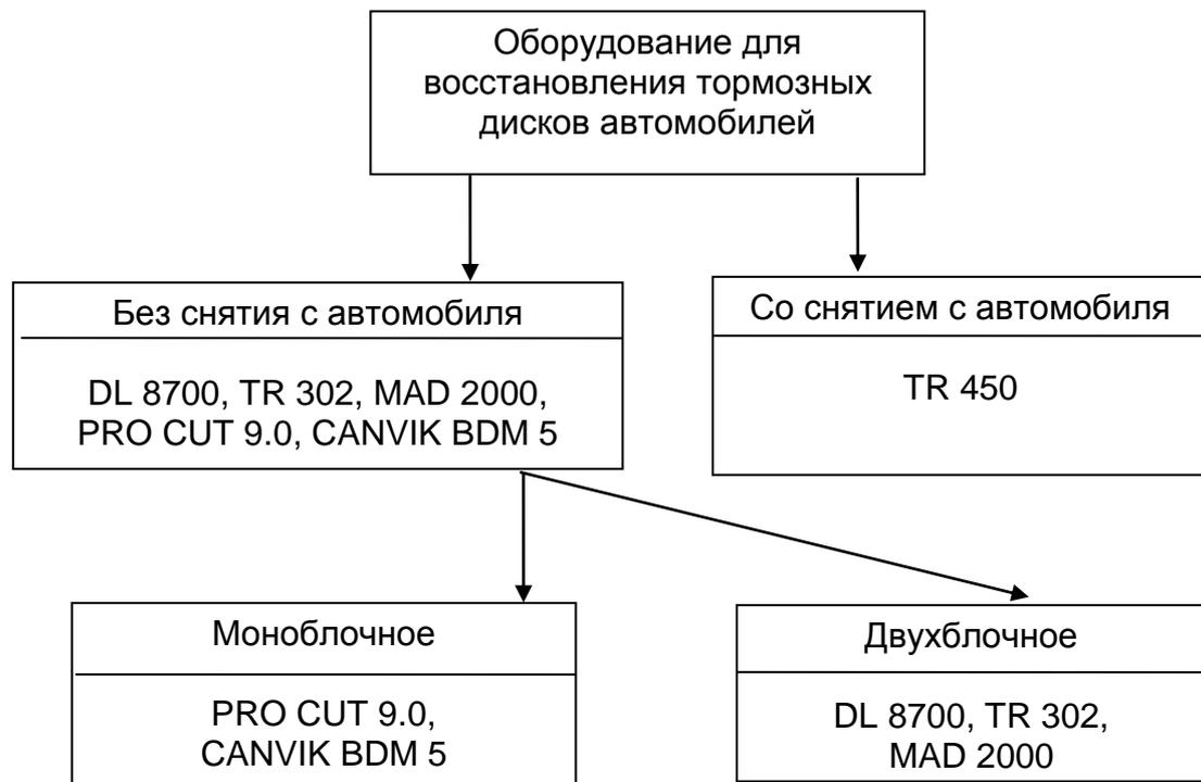
Рис. 1. - Оборудование для восстановления тормозных дисков автомобилей
