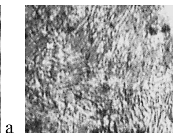
Рисунок – Микроструктура образцов со степенями деформации 0% (а), 94% (б), зависимость количества графитных включений от степени деформации (в), \times 1350
