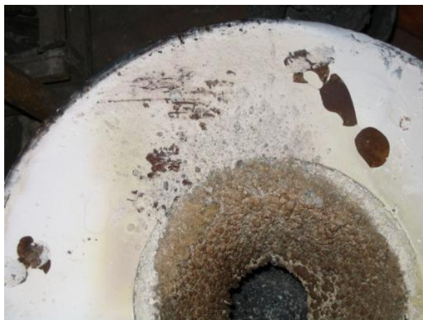
Рисунок - Кришка печі з нальотом кремнезему після плазмово-дугової плавки
