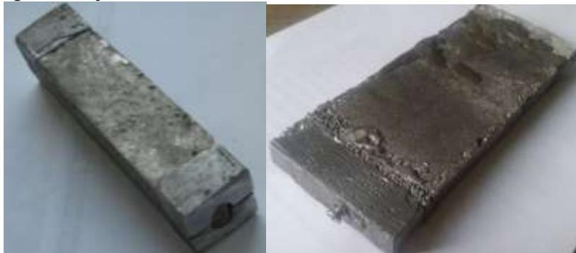
Рисунок 1 – Модельные образцы с жидкой сердцевиной
