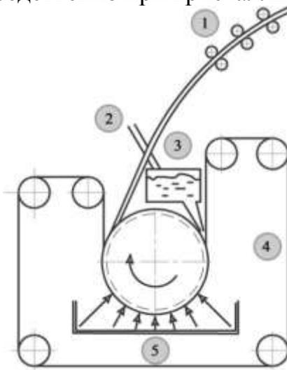
Рисунок - Принципиальная схема разливки меди на колесо:
