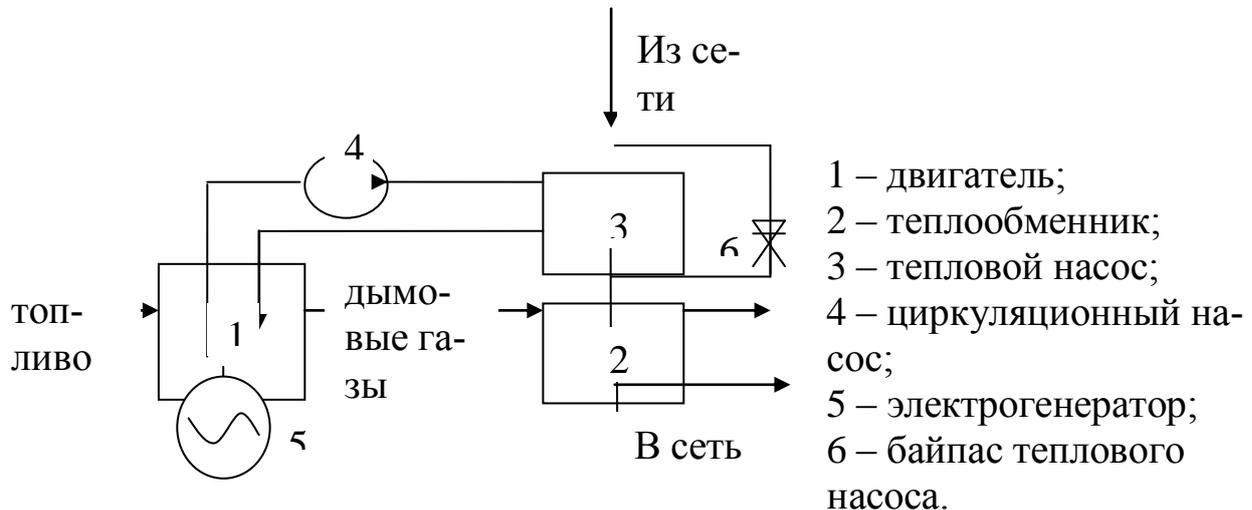
Топливо подается на двигатель, который соединен с электрогенератором. Продукты сгорания (дымовые газы) поступают в теплообменник сетевой воды. Двигатель охлаждается жидкостью, которая забирает у него часть тепла и после выхода имеет высокую температуру. Нагретая охлаждающая жидкость подается в тепловой насос, где отдает дополнительное тепло воде из обратной линии отопительной сети. Далее вода поступает в сетевой подогреватель, после которого в отопительную сеть.
