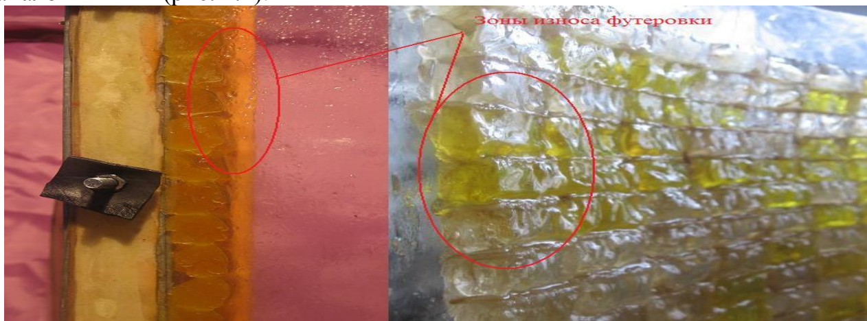
Рисунок 1.2 – Зоны размыва на плоской и объемной моделях
