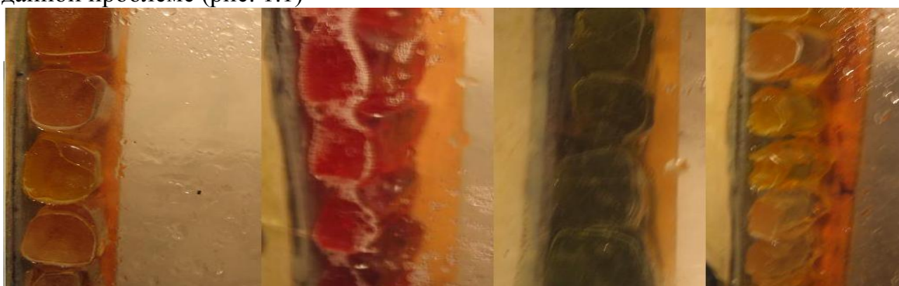
Рисунок 1.1 – Износ футеровки при различных положениях продувочных устройств
