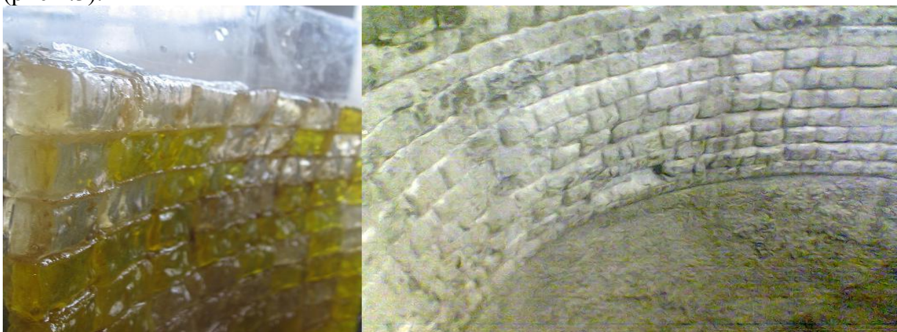
Рисунок 1.3 – Износ футеровки в объемной модели и в сталеразливочном ковше
