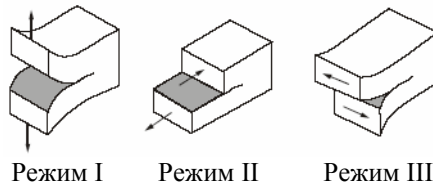
Рис. 1. Основные режимы образования трещины
