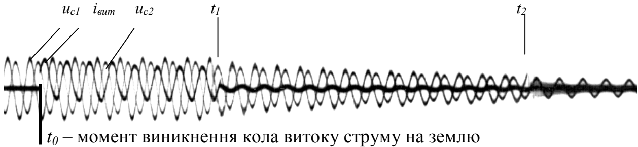
Рисунок 1— Осцилограми фазної напруги на вході ( u_{c1} ) і виході ( u_{c2} ), масштаб амплітуд зменшено) контактора пускача, струму витoku ( i_{вum} ) на землю в процесі захисного відключення приєднання з асинхронним двигуном потужністю 120 кВт в мережі 660 В
