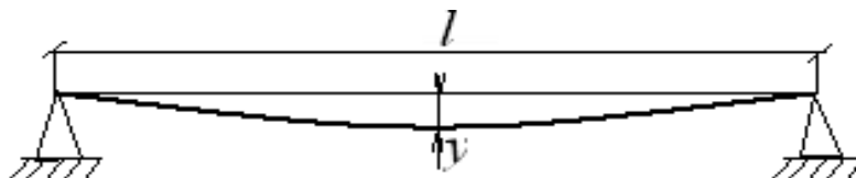
Рисунок 2.2.5. - Прогин балки, що спирається на дві опори
