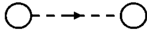
Рис. 2.3 – Зображення гілки вентиляційної мережі, яка моделює (відображає) виток повітря через вироблений простір
