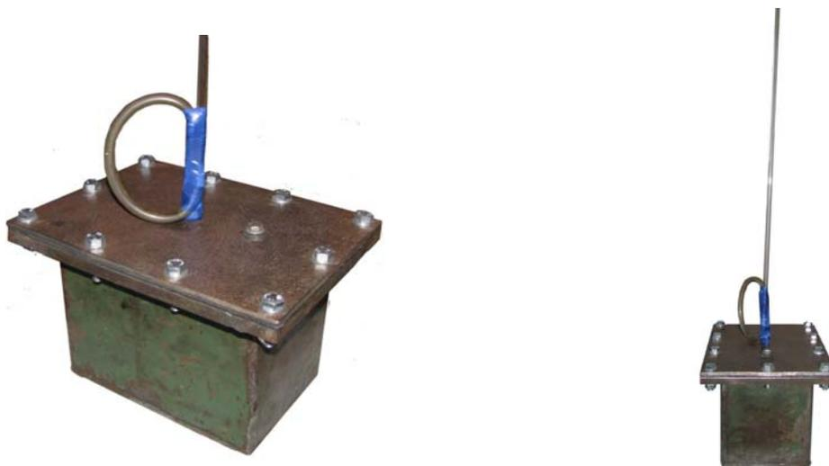
**Рис.1** - Установка для определения объёмного расширения бетонной смеси.
