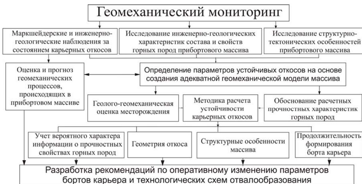
Рис. 1 – маркшейдерское обеспечение геомеханического мониторинга
