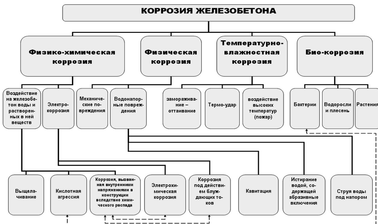
Рис. 1 – Классификация коррозионных процессов в железобетоне
