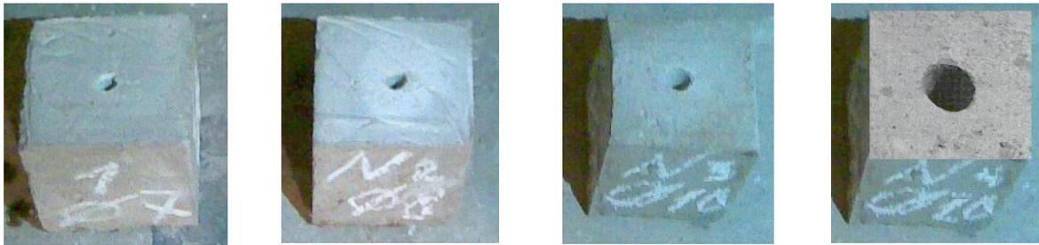
**Рис.1** – Вид цементно-песчаных моделей до заливки НРВ-80
