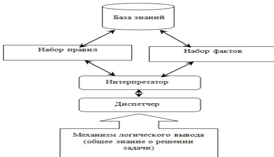
Рисунок 7 – Структурная схема работы системы Prolog
