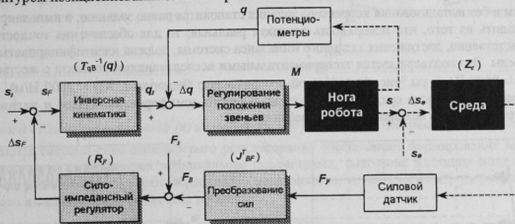
Рисунок 3 - Структурная схема сило-импедансного регулирования
