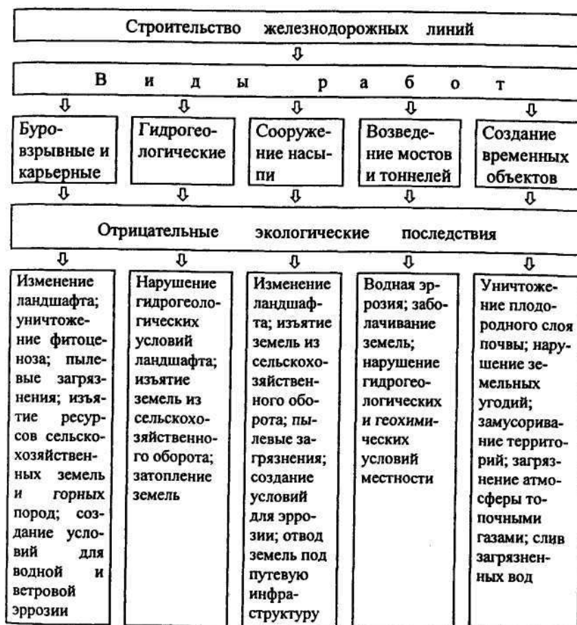
Рис. 4. Объекты и характер воздействий на экосистемы при строительстве железнодорожных линий
